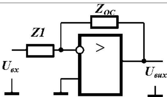
На рисунку надана загальна схема приладу на операційному підсилювачі (див. рисунок), що охоплений від'ємним зворотнім зв'язком. Яку математичну операцію над вхідним сигналом буде виконувати прилад, якщо елемент  $Z_1$  утворено **резистором**, а  $Z_{OC}$  – **конденсатором**?
