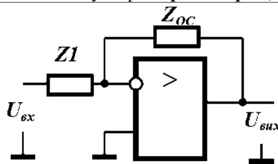
На рисунку надана загальна схема приладу на операційному підсилювачі (див. рисунок), що охоплений від'ємним зворотнім зв'язком. Яку математичну операцію над вхідним сигналом буде виконувати прилад, якщо елемент  $Z_1$  утворено **конденсатором**, а  $Z_{OC}$  – **резистором**?
