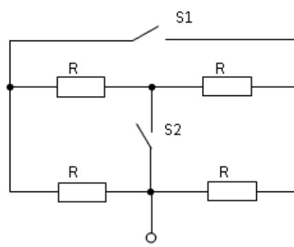
140. Проаналізуйте, як зміниться загальна сила струму в колі, якщо до двох послідовно з'єднаних резисторів паралельно під'єднати третій резистор (напруга на затискачах ланцюга залишається незмінною)?
