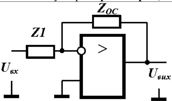
На рисунку надана загальна схема приладу на операційному підсилювачі (див. рисунок), що охоплений від'ємним зворотнім зв'язком. Яку математичну операцію над вхідним сигналом буде виконувати прилад, якщо елементи  $Z_1$  та  $Z_{OC}$  утворені **резисторами**?
