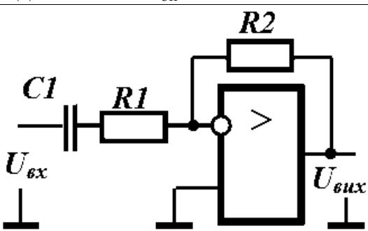
Як зміниться **смуга пропускання** інвертуючого підсилювача (див. рисунок), якщо ввести конденсатор в вхідне коло інвертуючого підсилювача? Вона
