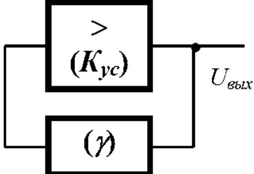
Комплексні коефіцієнти передачі елементів підсилювача зі зворотнім зв'язком (див. рисунок) мають вигляд:  $\bar{K}_{yc} = K_{yc} e^{j\phi_k}$ ;  $\bar{\gamma} = \gamma e^{j\phi_\gamma}$ , де  $K_{yc}, \gamma$  – модулі коефіцієнтів,  $\phi_k, \phi_\gamma$  – зсув фази гармонічного сигналу на деякій частоті. Нижче наведені деякі значення параметрів та варіанти відповідей щодо **можливості виникнення** гармонічних коливань у наведеній структурі на визначеній частоті
