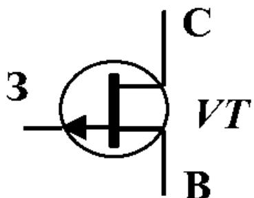
Польовий транзистор (див. рисунок) знаходиться в режимі **відсічення**. Вкажіть, що може призвести до **виходу** транзистора з цього стану.
