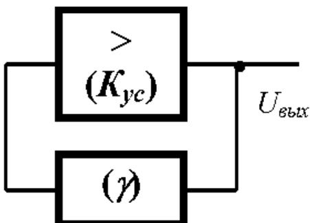
Комплексні коефіцієнти передачі елементів підсилювача зі зворотнім зв'язком (див. рисунок) мають вигляд:  $\bar{K}_{yc} = K_{yc} e^{j\phi_k}$ ;  $\bar{\gamma} = \gamma e^{j\phi_\gamma}$ , де  $K_{yc}, \gamma$  – модулі коефіцієнтів,  $\phi_k, \phi_\gamma$  – зсув фази гармонічного сигналу на деякій частоті. Нижче наведені деякі значення параметрів та варіанти відповідей щодо **можливості виникнення** гармонічних коливань у наведеній структурі на визначеній частоті
