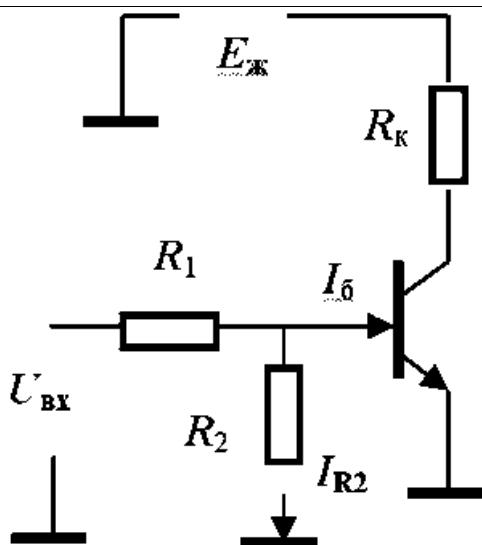
Яке з співвідношень треба виконати, щоб транзистор електронного ключа (див. рисунок) був в режимі **насичення**? **Примітки:** позначення струмів, що використані у виразах, збігаються з позначеннями на рисунку.  $h_{21E}$  – коефіцієнт передачі струму транзистора.
