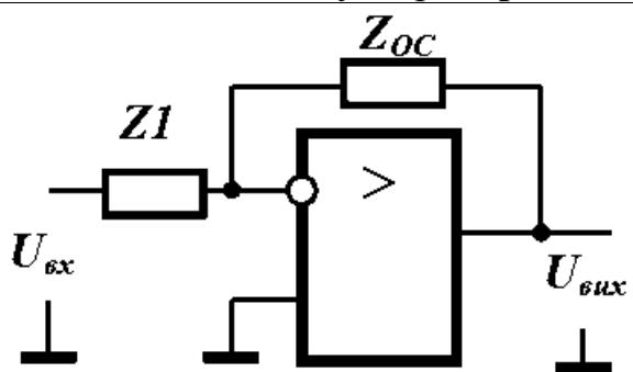
На рисунку надана загальна схема приладу на операційному підсилювачі (див. рисунок), що охоплений від'ємним зворотнім зв'язком. Яку математичну операцію над вхідним сигналом буде виконувати прилад, якщо елемент  $Z_1$  утворено **діодом**, а  $Z_{OC}$  – **резистором**?
