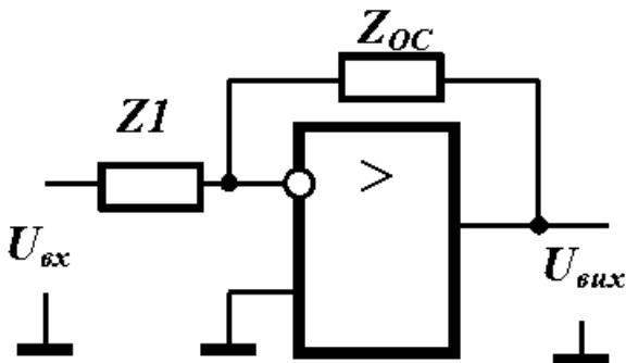
На рисунку надана загальна схема приладу на операційному підсилювачі (див. рисунок), що охоплений від'ємним зворотнім зв'язком. Яку математичну операцію над вхідним сигналом буде виконувати прилад, якщо елемент  $Z_1$  утворено **резистором**, а  $Z_{OC}$  – **діодом**?
