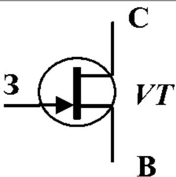
Польовий транзистор (див. рисунок) знаходиться в режимі **відсічення**. Вкажіть, що може призвести до **виходу** транзистора з цього стану.
