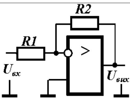
Вкажіть, чому дорівнює **вхідний опір** інвертуючого підсилювача (див. рисунок), у якому  $R1 = 2$  ком,  $R2 = 20$  кОм, а вхідний опір операційного підсилювача  $R_{\text{оп}} = 2$  МОм.
