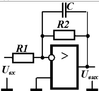
Як зміниться **смуга пропускання** інвертуючого підсилювача (див. рисунок), якщо ввести конденсатор в коло зворотного зв'язку інвертуючого підсилювача (див. рисунок)? Вона:
