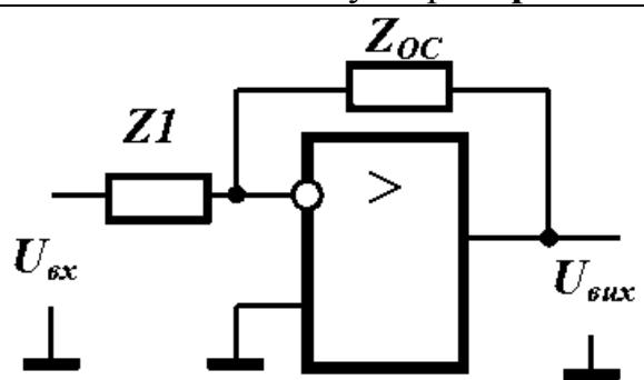
На рисунку надана загальна схема приладу на операційному підсилювачі (див. рисунок), що охоплений від'ємним зворотнім зв'язком. Яку математичну операцію над входним сигналом буде виконувати прилад, якщо елемент  $Z1$  утворено діодом, а  $Z_{OC}$  – резистором?
