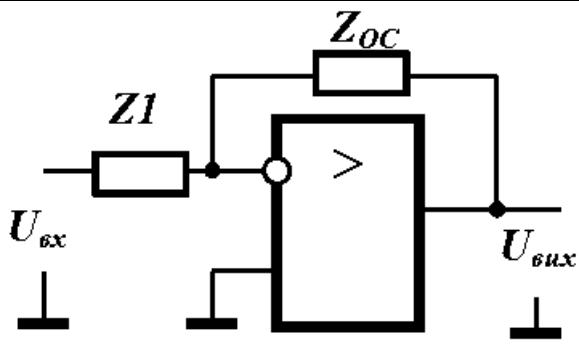
На рисунку надана загальна схема приладу на операційному підсилювачі (див. рисунок), що охоплений від'ємним зворотнім зв'язком. Яку математичну операцію над входним сигналом буде виконувати прилад, якщо елемент  $Z1$  утворено резистором, а  $Z_{OC}$  – діодом?
